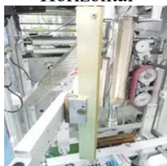
Gambar 10. Membersihkan Hotbar Vertikal
